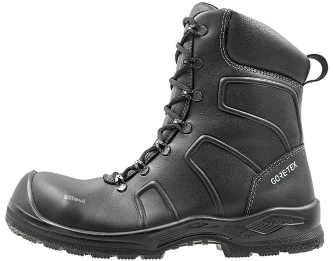
Conçue pour des conditions d'utilisation variables, la chaussure de sécurité GT 25+ a sa doublure directement revêtue d'une pellicule imperméable mais respirante en GORE-TEX. Protection des orteils en composite et protection antiperforation en acier. Dessus en cuir grain, fermeture éclair sur le côté intérieur et lacet sur le dessus, semelle amovible DUAL Comfort pour un confort accru.
