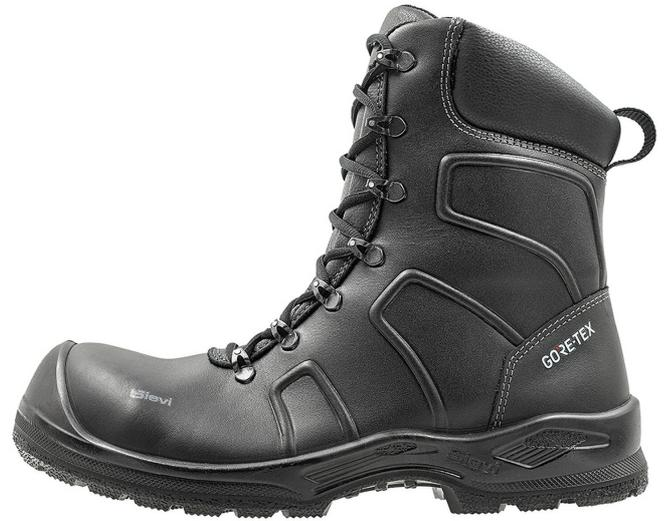
GT 25+ ist ein Sicherheitsschuh für wechselhafte Arbeitsbedingungen. Seine wasserdichte, atmungsaktive GORE-TEX-Membran ist durch Laminierung untrennbar mit dem Innenfutter verbunden. Das Obermaterial ist robustes Narbenleder. Mit Komposit-Zehenkappe, Stahl-Nageldurchtrittschutz, seitlichem Reißverschluss und zusätzlichen Schnürsenkeln sowie komfortablen DUAL Comfort-Einlegesohlen.
